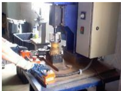
Abertura dos hidrômetros
