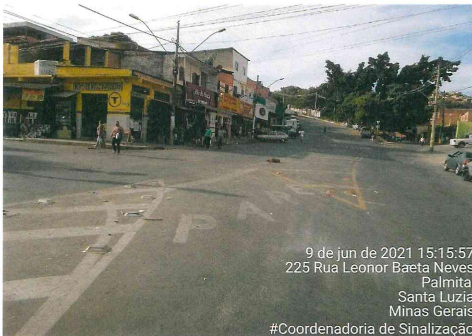
**Figura 2: Fotografia do mesmo local no dia 09 de junho de 2021, menos de 1 mês depois da implantação da sinalização. Nota-se os zebraados bem apagados (branco e amarelo), bem como a legenda de PARE e a linha de retenção**
