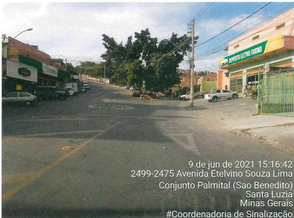
**Figura 4: Fotografia do mesmo local no dia 09 de junho de 2021, menos de 1 mês depois da implantação da sinalização – Destaque para o zebrado amarelo bem apagado**
