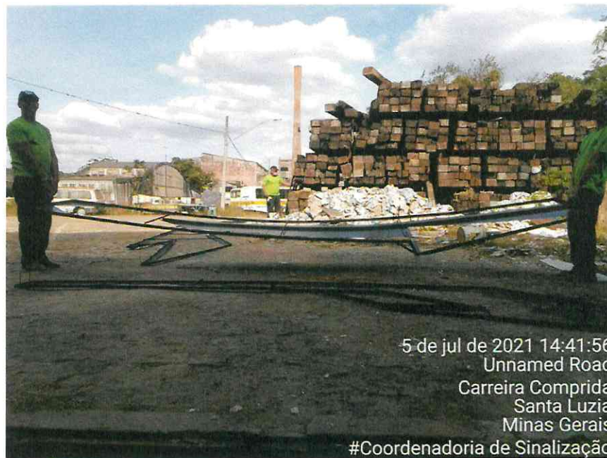
Figura 6: Destaque para o comprimento da peça, dificultando o manuseio e transporte (chapa fletindo no centro)
