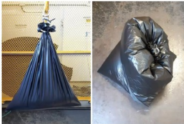
Figura 4. Ensaio de Resistência à Queda Livre.
