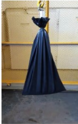
Figura 5. Ensaio de Verificação da Estanqueidade.
