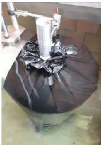
Figura 7. Ensaio de Determinação da Capacidade Volumétrica.
