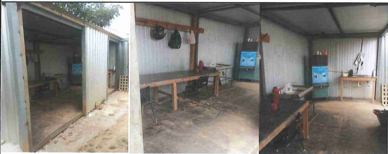
1.1.8 LOCAÇÃO DE CONTAINER COM ISOLAMENTO TÉRMICO, TIPO 4, PARA REFEITÓRIO DE OBRA, COM MEDIDAS REFERENCIAIS DE (6) METROS COMPRIMENTO, (2,3) METROS LARGURA E (2,5) METROS ALTURA ÚTIL INTERNA, INCLUSIVE LIGAÇÕES ELÉTRICAS INTERNAS, EXCLUSIVE MOBILIZAÇÃO/DESMOBILIZAÇÃO E LIGAÇÕES PROVISÓRIAS EXTERNAS
