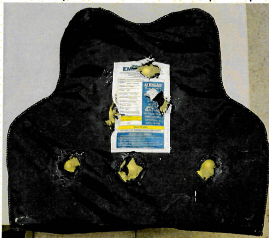
Figura 7: Placa frontal após submissão aos disparos para teste balístico.
