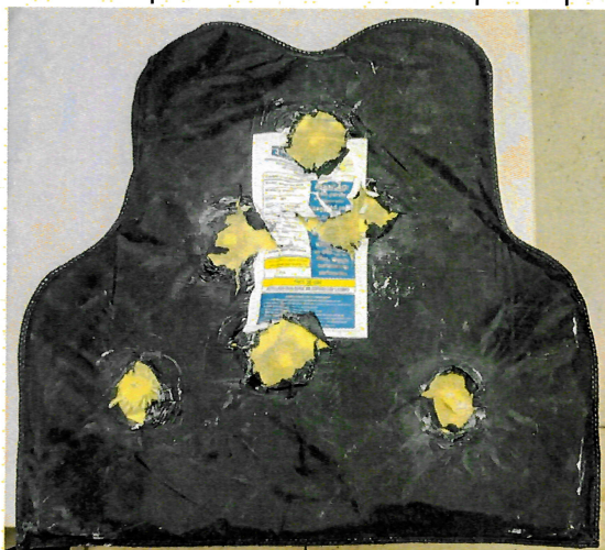
Figuras 5: Placa dorsal após submissão aos disparos para teste balístico.
