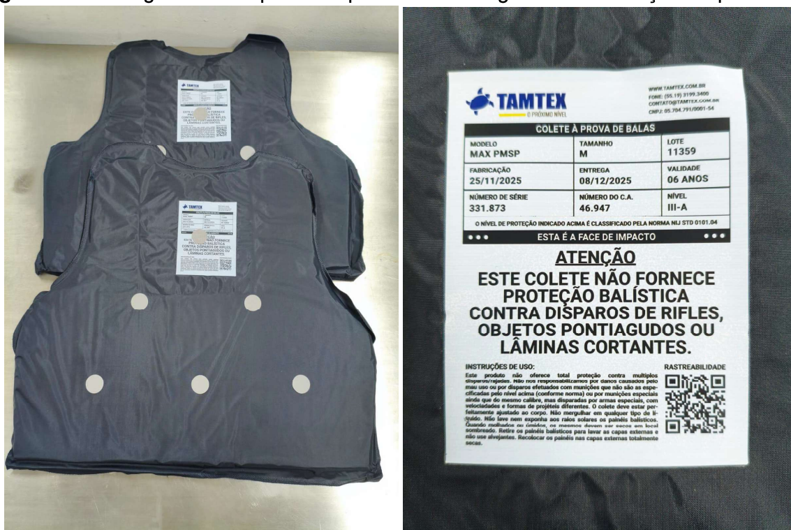
Figura 2: Locais gerais de impacto no painel de blindagem e identificação do painel.
