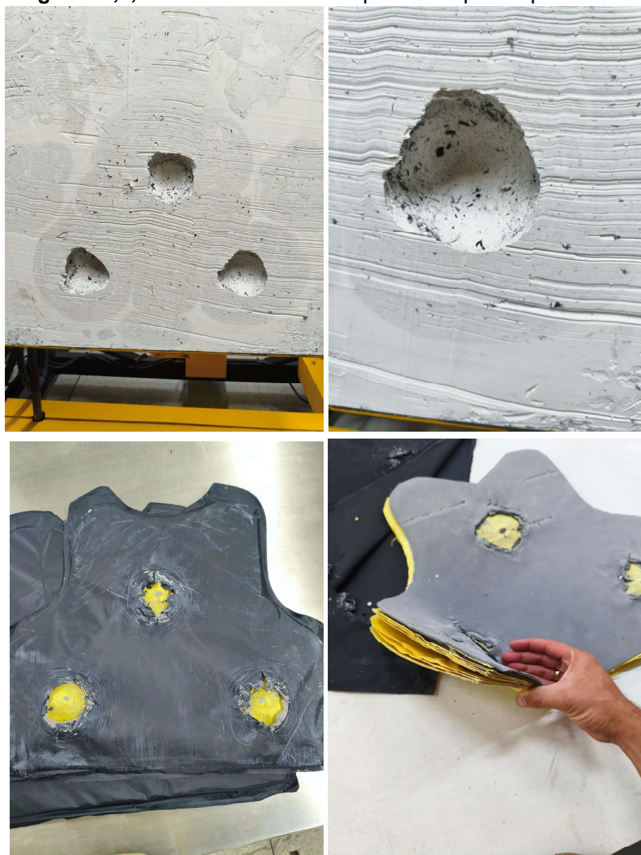
Figuras 3,4,5 e 6: Painel balístico e plastilina após disparo nº 03.
